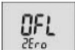
Au cas où la pression mesurée (0 bar) serait supérieure à 5% du champ de mesure, apparaît **OFL/Zero** (3 s).
