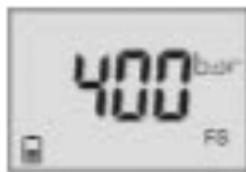
Indicación del rango de medición (FS)
