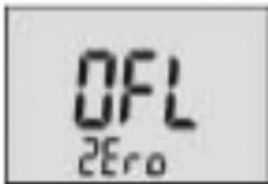
Si la presión medida (0 bar) es mayor del 5% del rango de medición, aparece **OFL/ZERO** (3 s).
