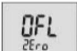
Se la pressione misurata (0 bar) è superiore al 5% del campo di misura, viene visualizzato **OFL/ZERO** (3s).
